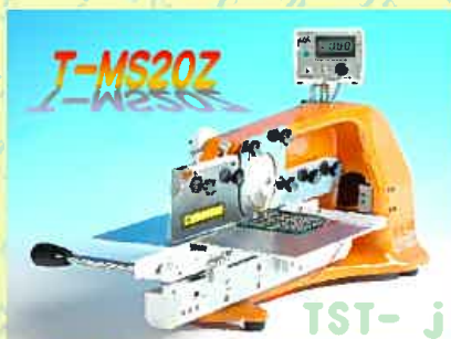
小型基板の最大基板 200mm
