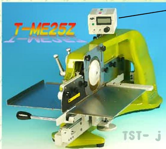
大型ディスク160mm効果の最大基板250mm
